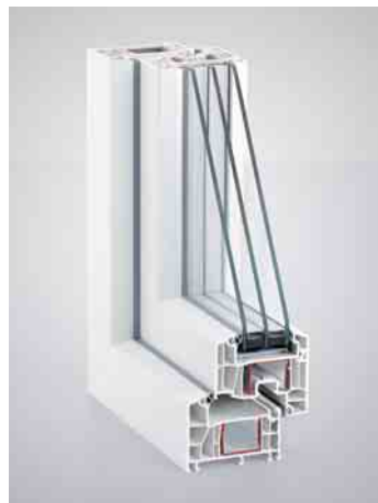
Plastové okno, 6 komor, zasklení trojsklem
