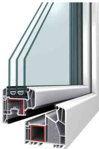
Plastové okno, 6 komor, zasklení trojsklem
