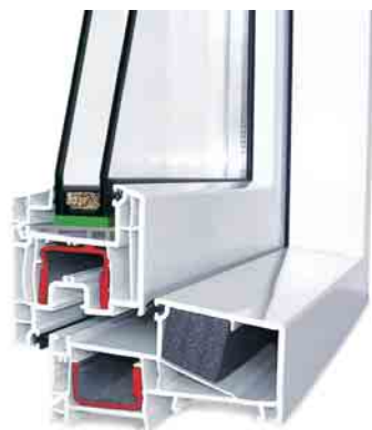
Plastové okno, 4 komory, zasklení dvojsklem
